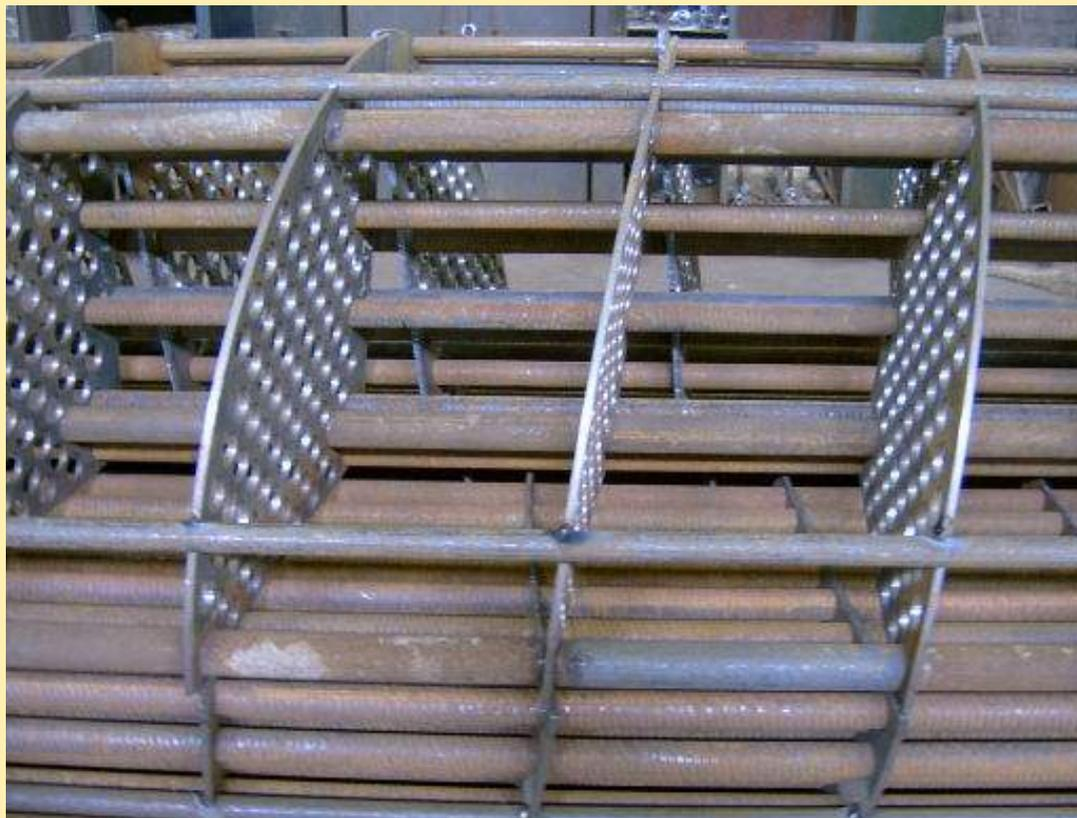
正在制造的螺旋折流板高效换热器管束
