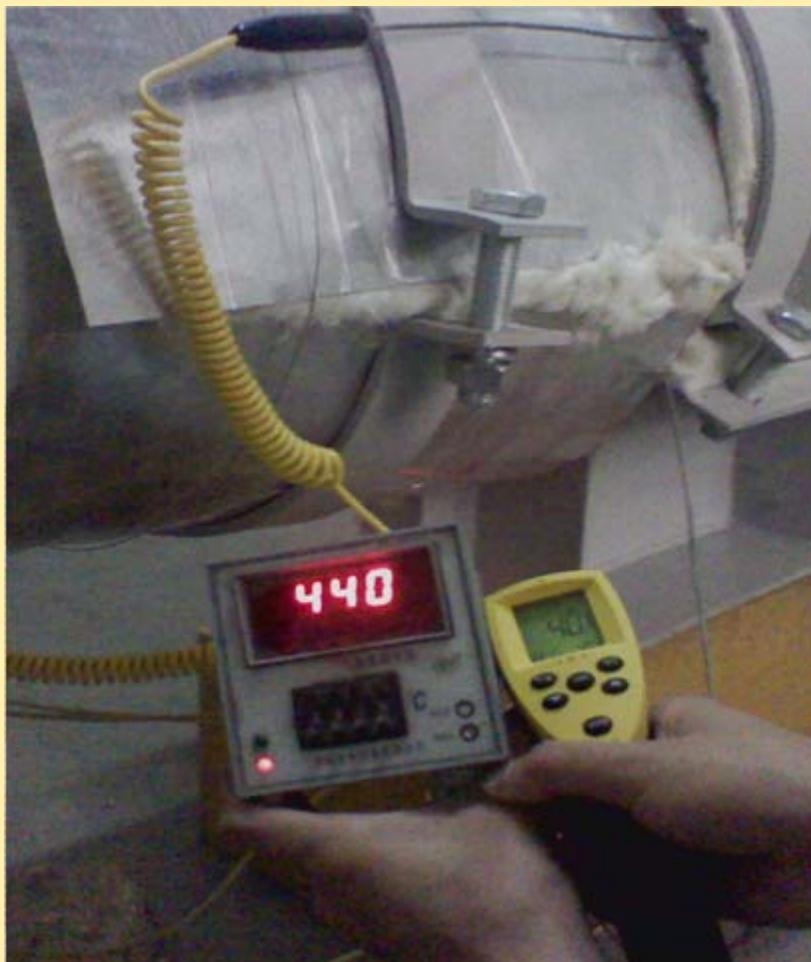
隔热管托温度测试实验
