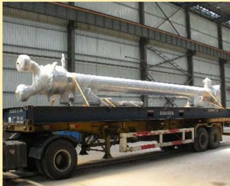
DE-201 Ti/N06600  $\Phi=711\text{mm}$ ;
