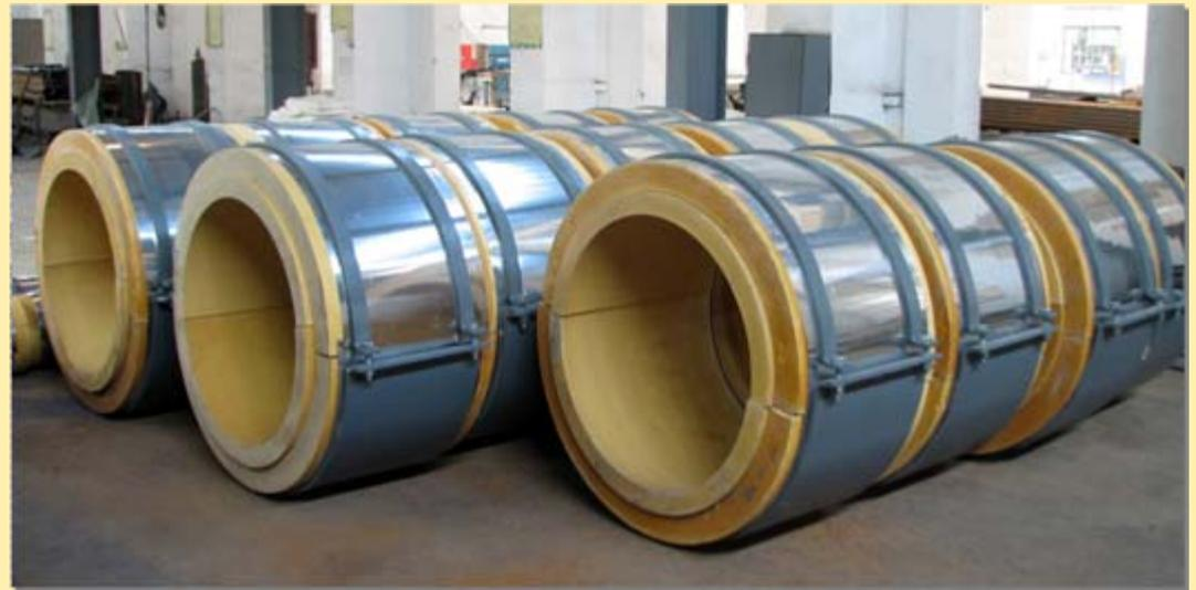
福炼低温乙烯管道用保冷管托
