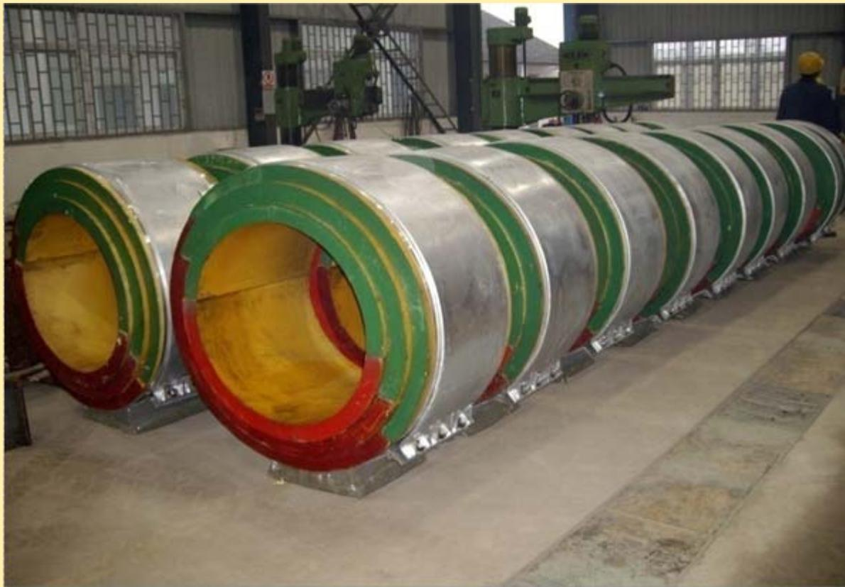
上海燃气LNG项目保冷管托
