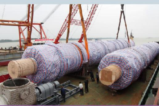
ROTARY STEAM TUBE DRYER
