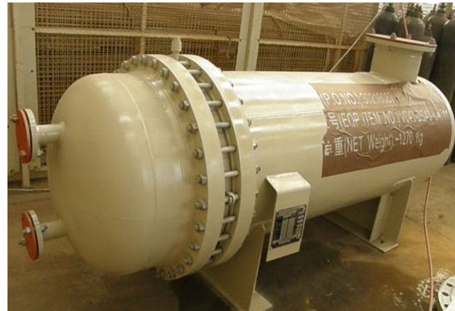
最终冷凝器 Falling Condenser Material: 00Cr19Ni10 (304L) Size: DN1100×8 L=4135
