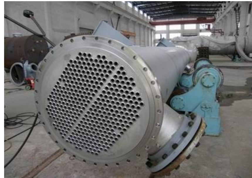
换热器 Heat Exchanger
