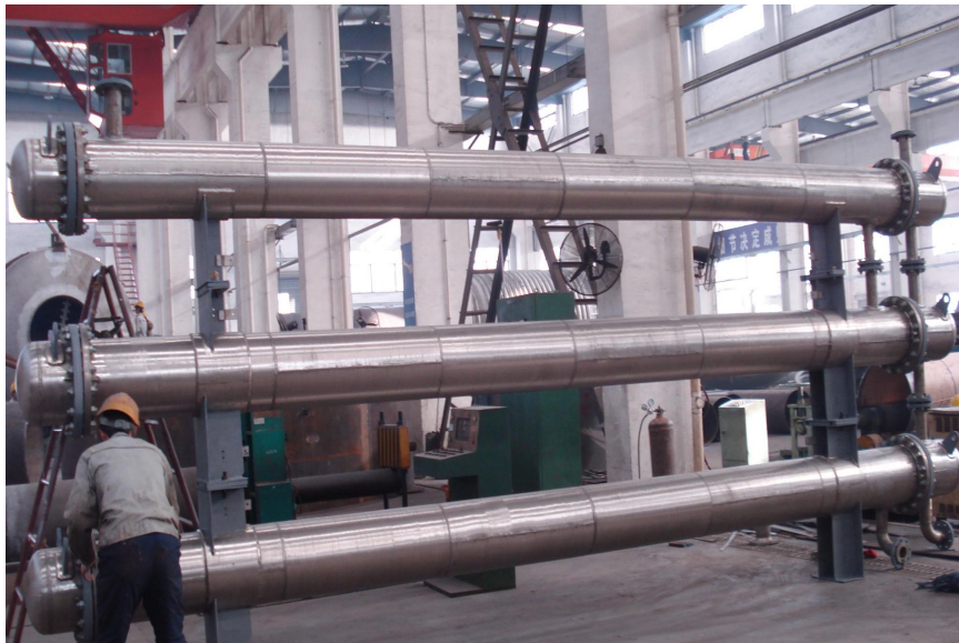
一效1 # 烧碱预热器 Alkali Pre-heater Material: Ni200 (No2200) Size: DN377×8×6854×3台
