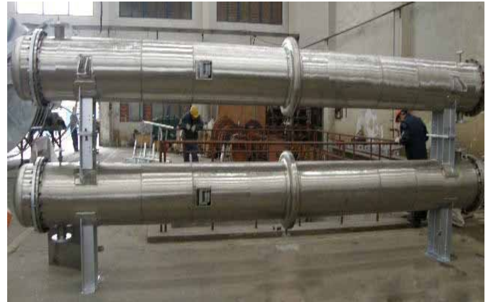
1 # 碱预热器 Alkali Pre-heater Material: Ni200 (No2200) Size: DN500×6710×2台串联
