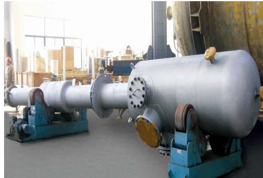
I 效蒸发器 I -effect Evaporator
