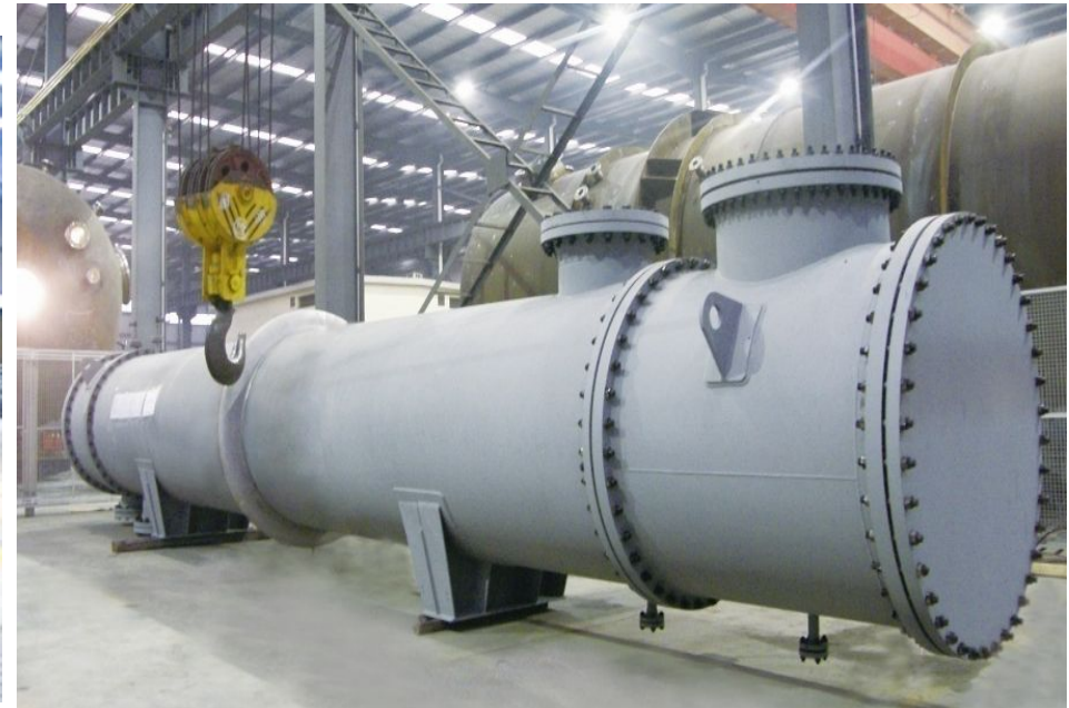
高沸塔冷凝器 High Boiling Tower Condenser
