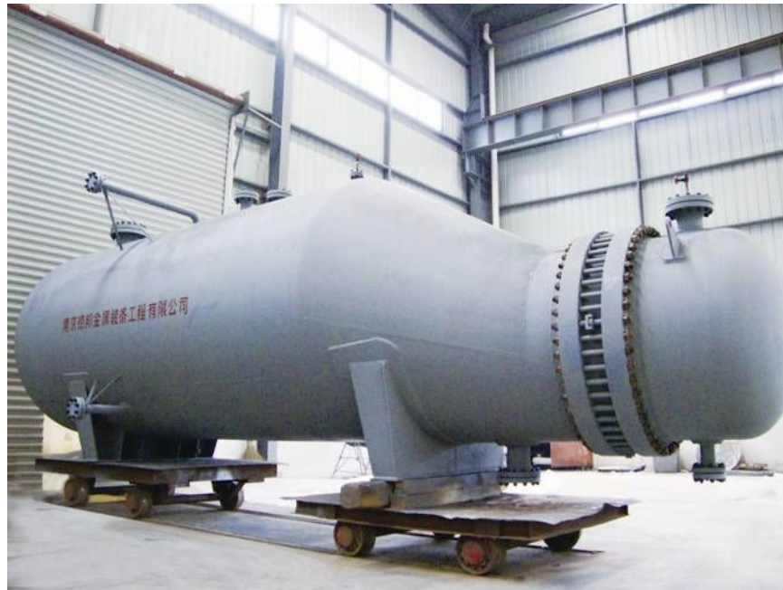
EDC蒸发器 Evaporator
