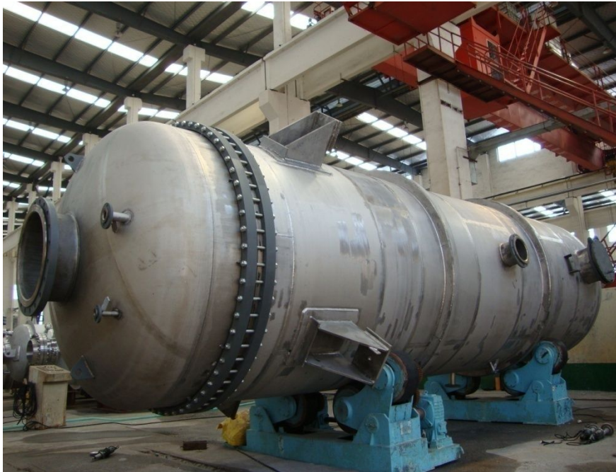
脱氯盐水塔 De-chlorine Brine tower
