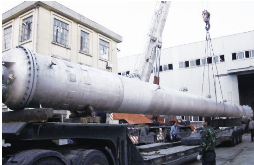
产品蒸馏塔 Distillate Tower Material: 317L Size: DN1200×40000
