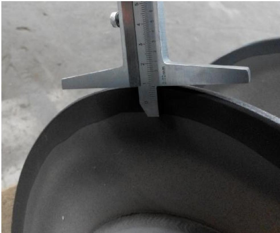
喷涂后叠螺污泥脱水机——螺旋轴
