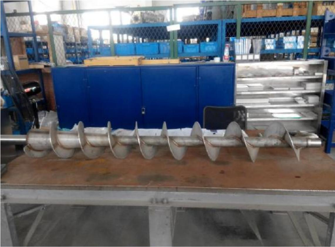
喷涂前叠螺污泥脱水机——螺旋轴
