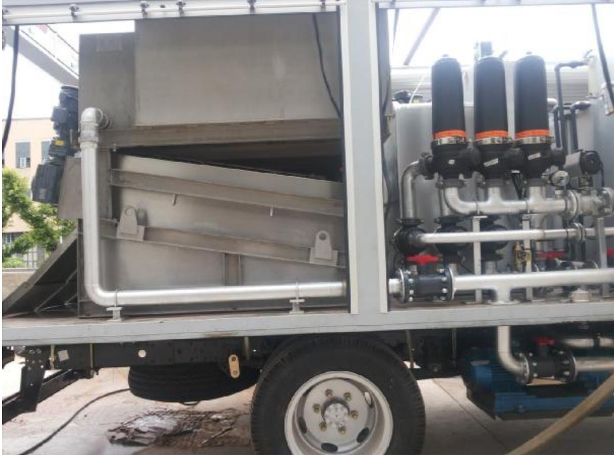
车载式叠螺污泥脱水机
