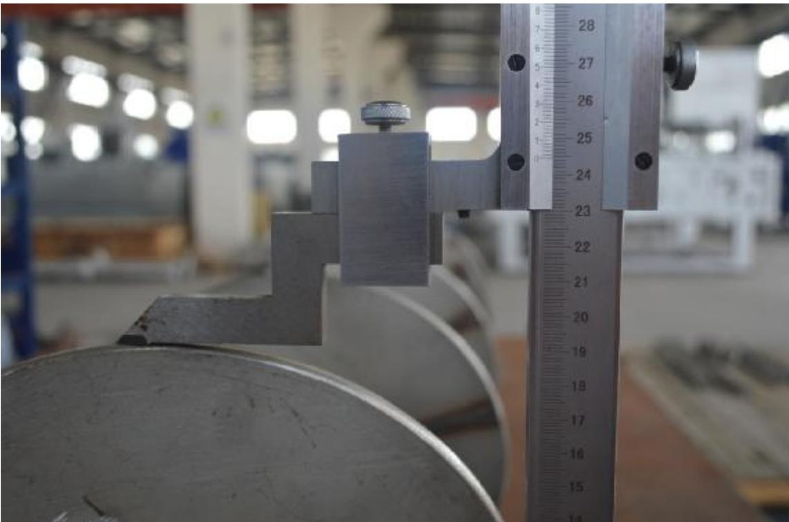
喷涂前叠螺污泥脱水机——螺旋轴
