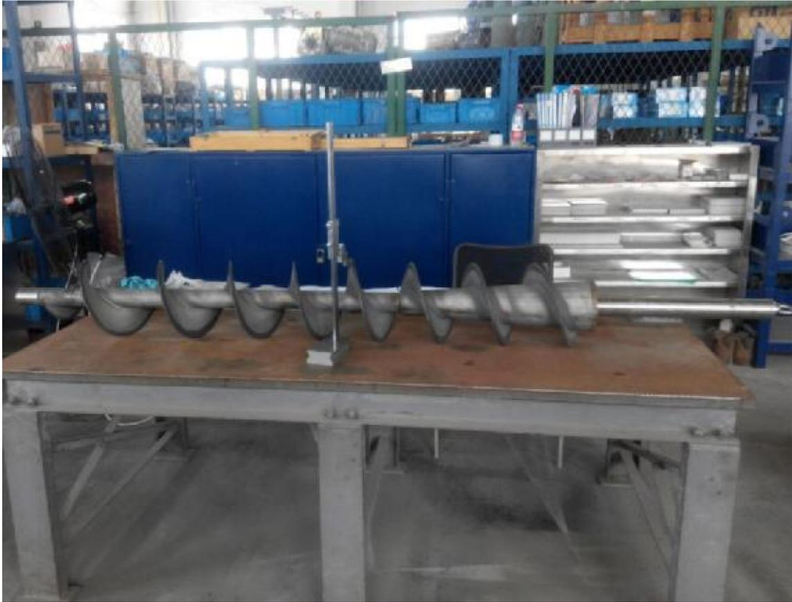
喷涂后叠螺污泥脱水机——螺旋轴
