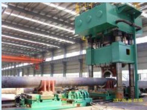
国内首台”大口径钢管校直升降旋转输送装置”
