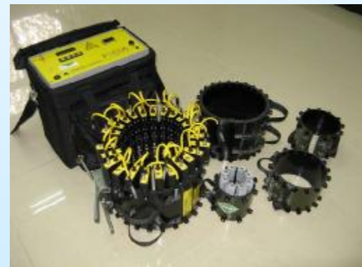
Teletest Mk3 长距离管道 超声导波检测系统
