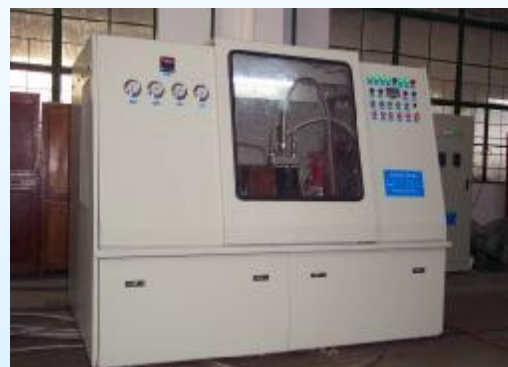
国内首套自动化汽车用空压机性能综合试验装置
