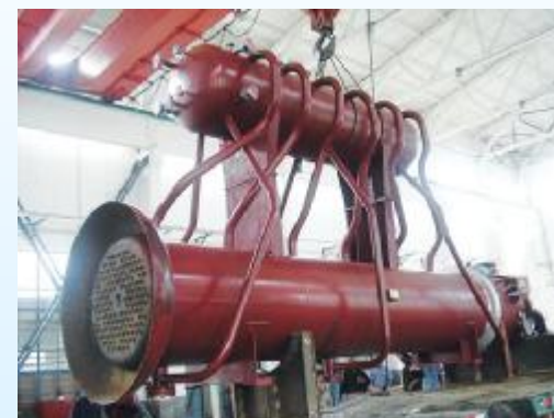
余热脱硫回收装置
