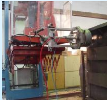
铁路货车除锈生产线
