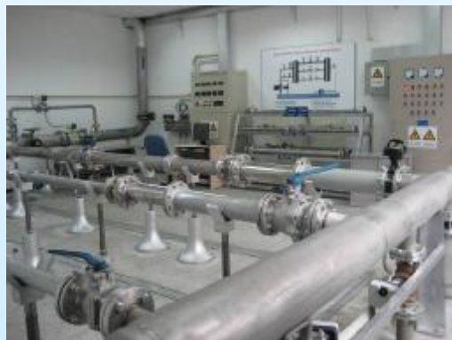
阀门流量流阻试验装置
