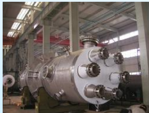
国内第一台自主设计的大型多股流缠绕管式换热器
