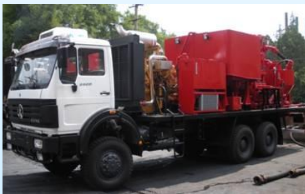
固井压裂设备
