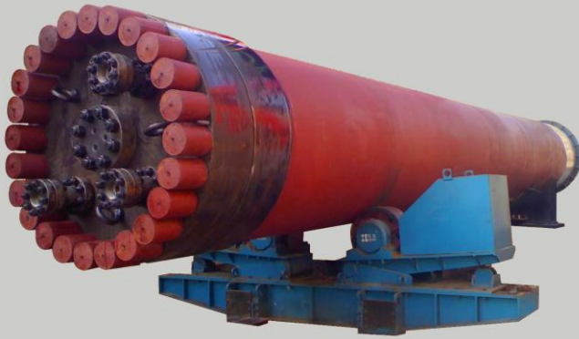
多层高压设备
