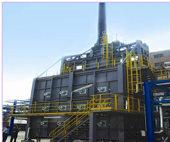
4. **反应及转化加热炉**：我们成功突破了管内反应吸热模型设计等技术难点，研制的CS<sub>2</sub>裂解炉、四氯化碳反应炉等已顺利开车。
