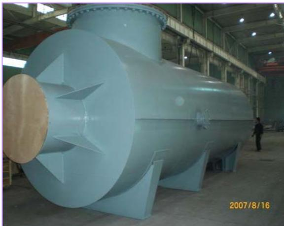
3. **热风炉**：可以提供50~1000万大卡/时温度达到350℃以上的热风，全自动运行，在化肥行业有较广泛应用，典型应用有煤制甲醇、煤基烯烃等装置磨煤工段干燥装置。典型客户包括了神华宁煤、大唐国际、云天化等。
