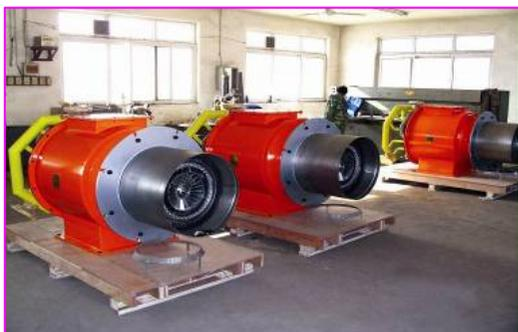
低NO<sub>x</sub>油气混合燃烧装置
